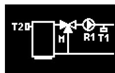
Schemat z zaworem 3-drogowym na zasilaniu
