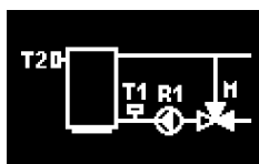
Schemat z zaworem 3-drogowym na powrocie
